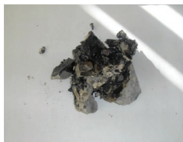
Calcari di base oligocenici, non impregnati di bitume
